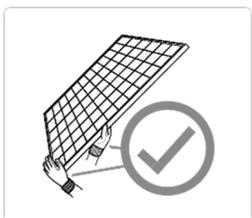
Während der Handhabung des Moduls und während der Installation müssen isolierte Handschuhe getragen werden.
